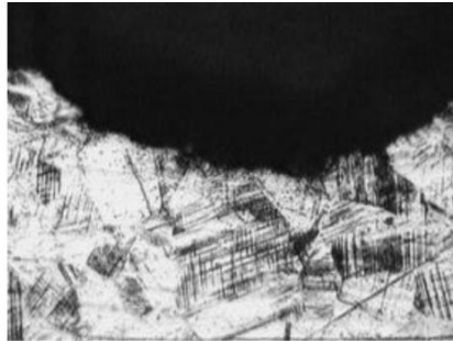
Chapeletas Petzl, detalhe da superfície corroída 800 x
