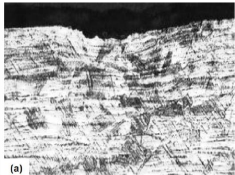
Chapeletas Bonier, detalhe da superfície corroída 400 x
