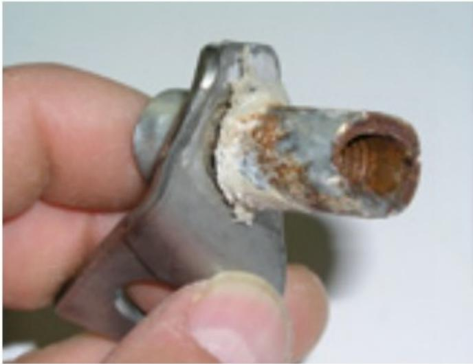
Corrosão entre o parafuso e o cone de expansão (não visível externamente)
