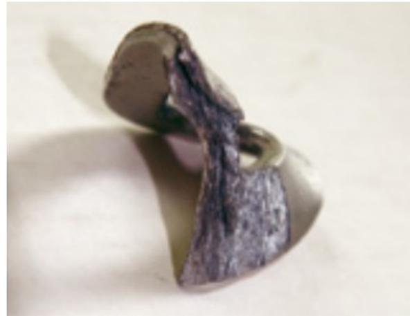
Corrosão de contato entre dois metais (efeito pilha)
