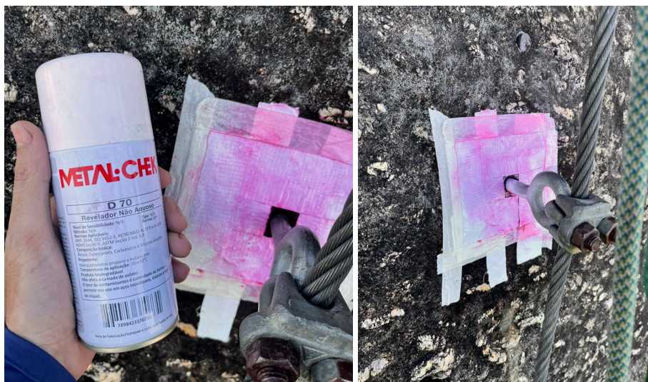
Figura 6 - Etapa final de revelação do ensaio de líquido penetrante em ancoragem similar.
