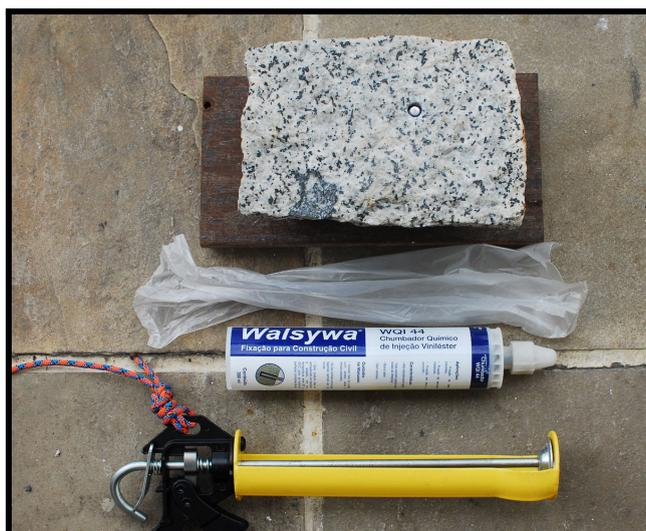
Figura 53: bloco para prática de recuperação da rocha com cola e aplicador.
