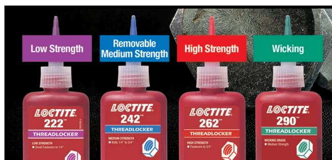
Figura 30: Loctite 222 - baixa resistência; 242 - média resistência e feito para repor torque ou remover; 264 - alta resistência; 290 - média resistência com ação capilar entre os filetes da porca e parafuso.
