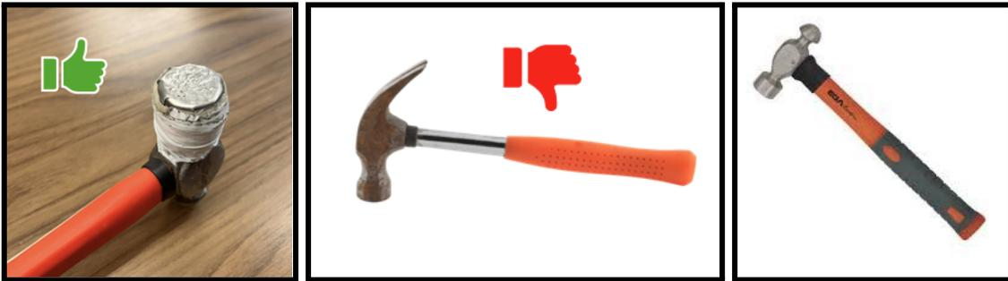
Figura 43: Esquerda, martelo preparados para evitar contaminação por ferro no inox do chumbador. Centro martelo inadequado com oxidação. Direita, martelo em inox.
