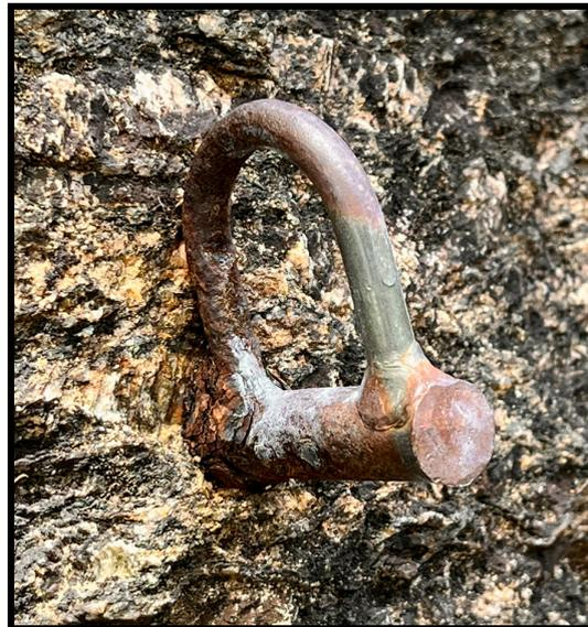
Figura 33: Segunda proteção da via “Ainda Não” antes da reforma em novembro de 2024, exibindo severa deterioração por corrosão ambiental na região de contato com a rocha. A gravidade da corrosão no furo permanece incerta.
