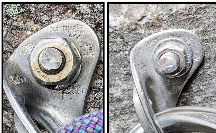
Figura 45: Proteção instalada sem atenção ao martelo: à esquerda em AISI 316L e porca A4, e à direita AISI 304 e porca A2, ambas com sinais de corrosão por contaminação.
