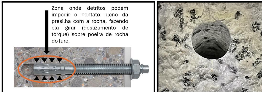
Figura 23: À esquerda, ilustração da zona crítica de limpeza; à direita, exemplo da qualidade esperada para a limpeza de um furo.
