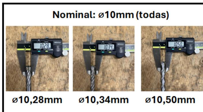
Figura 16: exemplos de diâmetro de várias brocas vendidas como 3/8", porém são brocas com diâmetro de corte de 10 mm nominal.
