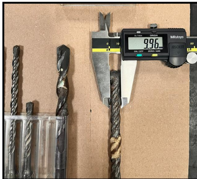
Figura 21: broca em polegada, diâmetro de corte levemente acima do nominal 9,5 mm, correto para um chumbador de 3/8".
